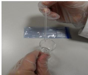
Pour les substances suspectes en liquide (comme p.e. la GHB), utilisez les pipettes fournies et mettez une goutte dans l'ampoule.
