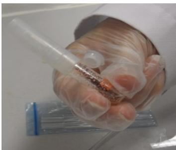
Comparez la couleur avec le codage par couleur imprimé sur l'ampoule.
